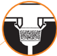
Správně naplněná plnicí komora
