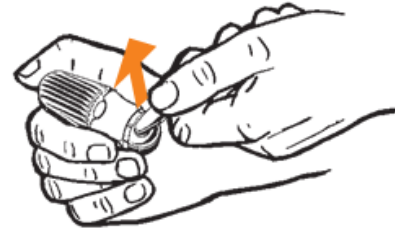
Vyjmutí náustku z krytu chladicí jednotky
