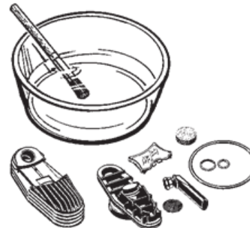
Ruční čištění rozložené chladicí jednotky
