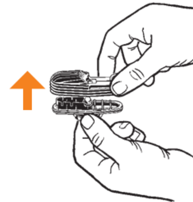
Vytáhněte kryt chladicí jednotky z její základny
