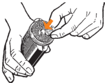
Plnění plnicí komory plnicím nástrojem
