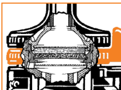
Jen částečně naplněná komora s polštářkem na tekutiny umístěným na vrchní straně
